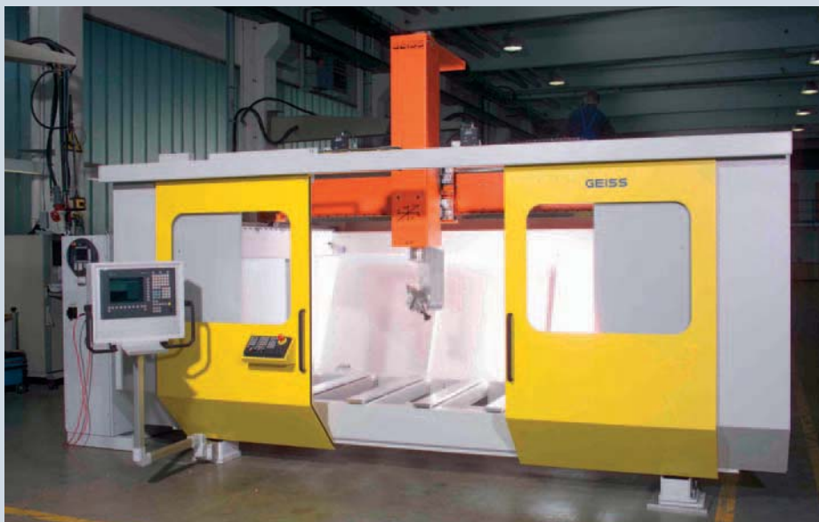
2: Hochproduktive CNC-Fräsmaschine Geiss FZ ECO für die Weiterverarbeitung von vakuumgeformten Kunststoffteilen
