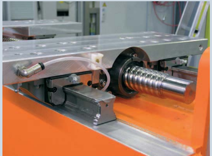
5: Schmierstoffdepots in den Führungswagen verlängern die Wartungsintervalle.
