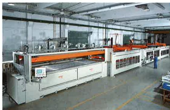
Vakuumformen, Beschicken und CNC-nachbearbeiten in einem: Baureihe TT-in-one
