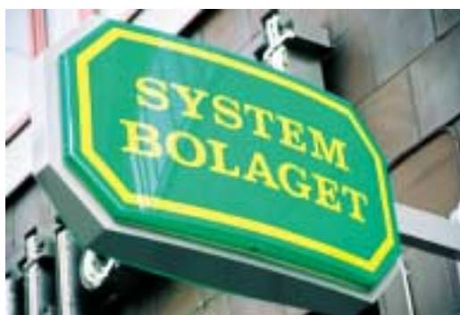
Systembolagets nya skyltar är screentryckta, vakuumformade och därefter kantfrästa i den nya fräsen.
