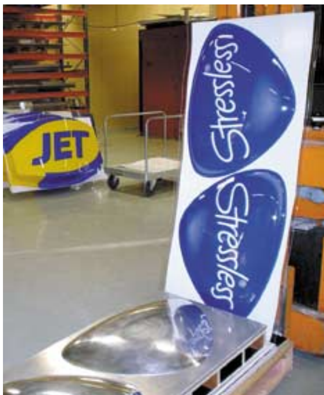
Stora vakuummaskiner tillåter stora skyltformat. Avancerade former kan nu produceras utan att skyltarna behöver skarvas vilket ökar skyltarnas livslängd.
