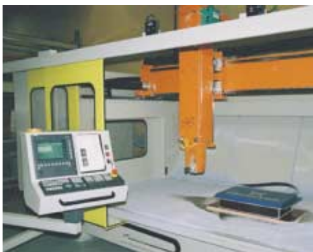
Den nya fräsen möjliggör håltagning och konturfräsning i alla axlar.
