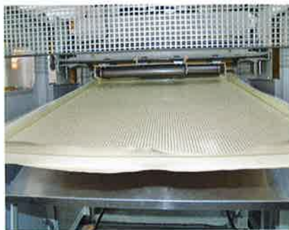
Zwei Folien mit kleinen eingeformten Pyramiden bilden die Mittelschicht einer neuartigen Sandwichplatte für den Leichtbau
