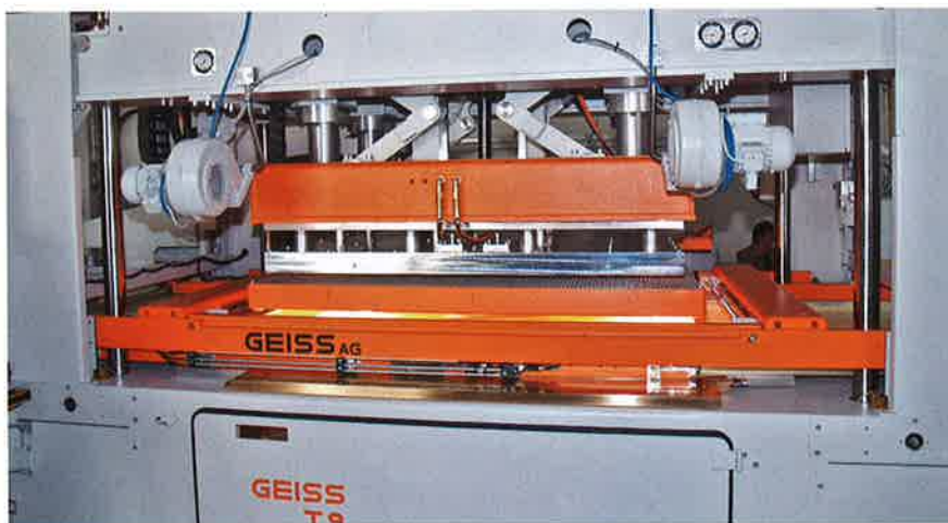
Durch Einsatz eines 5-Punkt-Kniehebelsystems erreicht die Twin-Sheet-Thermoformmaschine T9 Schließzeiten von unter einer Sekunde (Fotos: Gotzmann)
