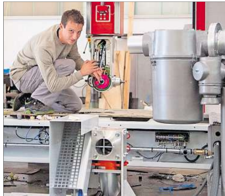
Im Schnitt 120 Maschinen pro Jahr: Das Bild zeigt Feinmechaniker Bernd Weikard bei der Fräskopf-Montage einer CNC-Nachbearbeitungsmaschine.
