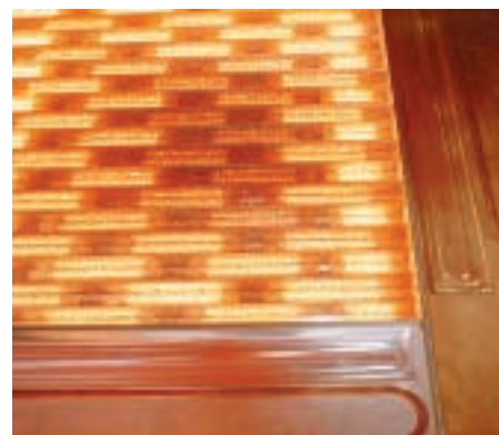
Bei Geiss wird jeder Strahler einzeln in seiner Intensität geregelt
