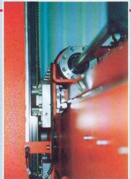
Durch die angetriebene Mutter sind hohe Geschwindigkeiten auch auf langen Strecken möglich: Die Verfahrwege der Vorschubachsen betragen bis zu 6,5 Meter.
