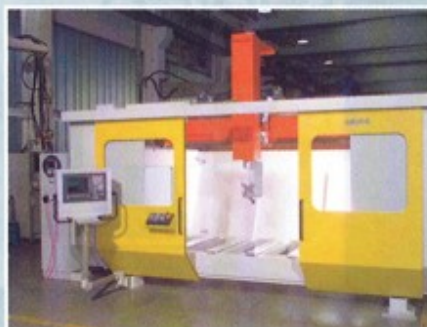
Hochproduktive CNC-Fräsmaschine Geiss FZ ECO für die Weiterverarbeitung von vakuumgeformten Kunststoffteilen.
