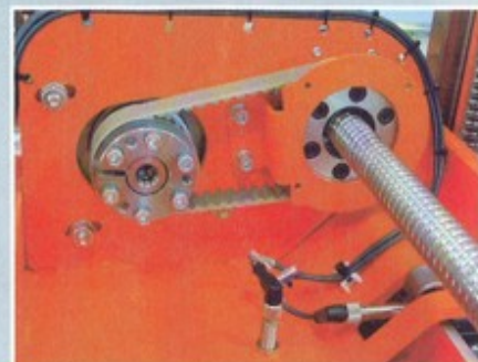
Konstruktionsbedingt für hohe Drehzahlen geeignet: Servomotoren treiben über Zahnriemen die Rexroth-Muttern an.
