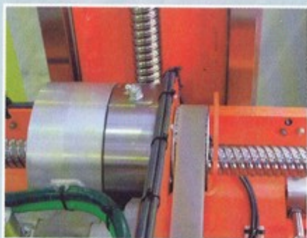
Schmieranschluss der angetriebenen Mutter. Ein Aluminiumring im Anschluss an die Mutter dient der Adaption des Faltenbalgs.
