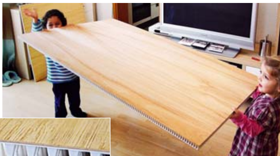
Die Sandwichplatten sind extrem leicht. Dafür sorgen die thermoplastischen Kerne. Sie bestehen aus zwei Folien mit eingeformten Kegeln, die an ihrer Spitze miteinander verschweißt sind (Twin-Sheets) Bilder: Genima
