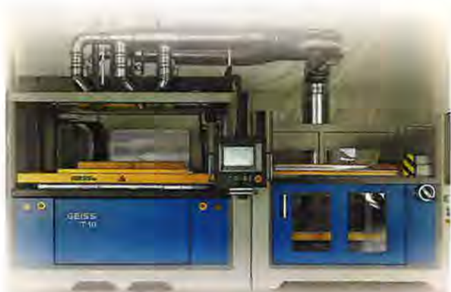
Blick auf die neue Thermoformanlage T10: Statt Druckluft kommen hochdynamische Servomotoren der Firma Siemens zum Einsatz Foto: Geiss
